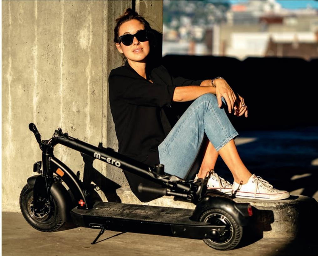
Dank des austauschbaren Batteriesystems des **micro Condor II (DE)** sind auch größere Distanzen mit dem E-Scooter kein Problem. Pro Batterieladung beträgt die Reichweite bis zu 25 Kilometer. Für längere Strecken kann die im Deck verbaute Batterie ganz einfach ausgewechselt werden.
